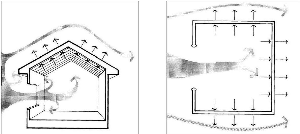
Se a edificação for totalmente impermeável ao ar, a pressão interna não terá variação, porém as edificações em geral possuem portas e janelas que permitem entrada do fluxo de ar
