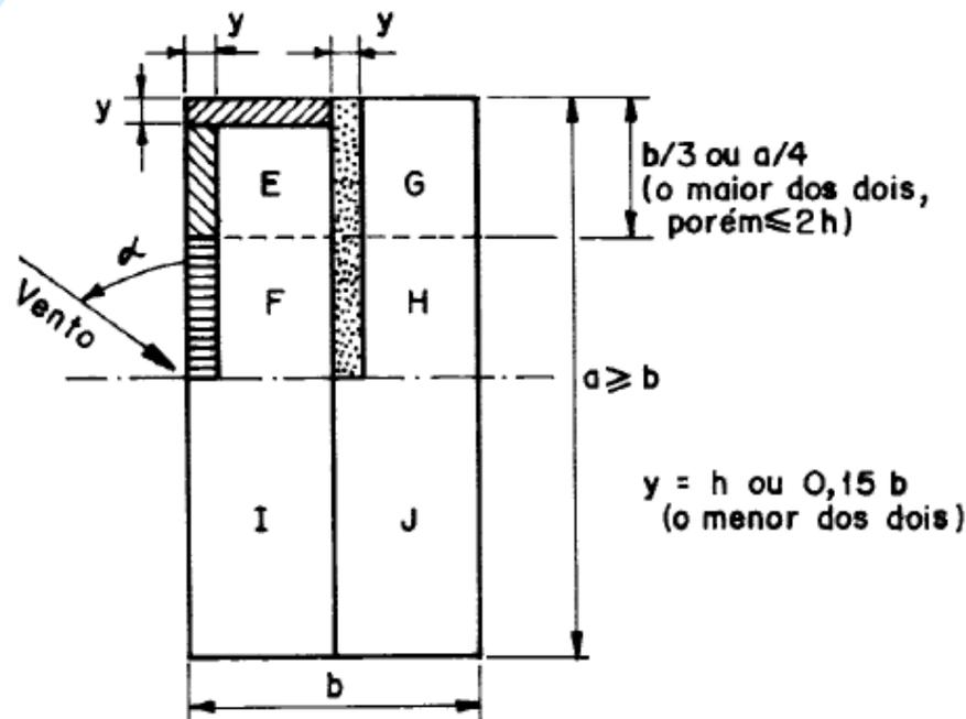
Notas: a) O coeficiente de forma  $C_{pe}$  na face inferior do beiral é igual ao da parede correspondente.
