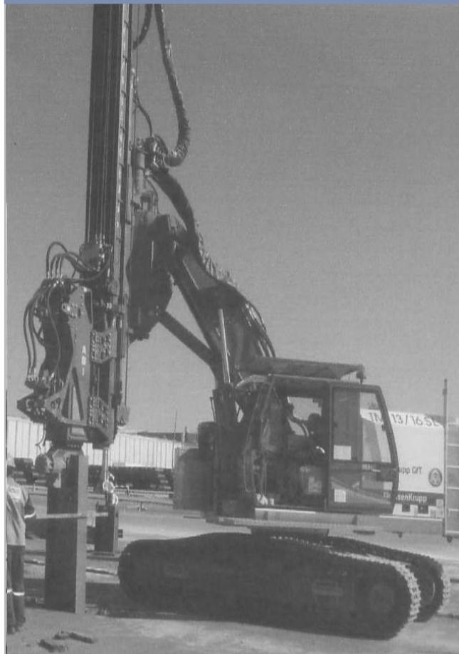
As massas excêntricas devem girar com sincronismo criando forças centrifugas ascendentes e descendentes ( $+F_v$  e  $-F_v$ ) cujo mecanismo é exposto na Figura 12. O sincronismo se faz necessário para que se anulem as componentes horizontais das forças ( $F_h$ ) conforme se mostra na Figura 12 (ii) a fim de evitar propagação de vibrações horizontais no terreno.
