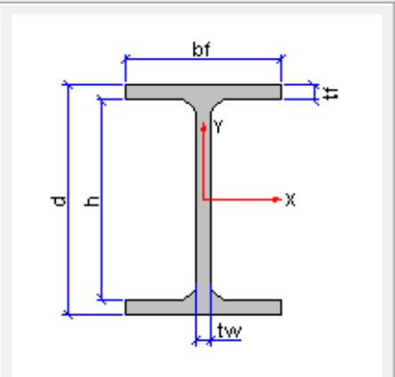
Perfil indicado para elementos sujeitos à flexão composta (Ex.: vigas)
