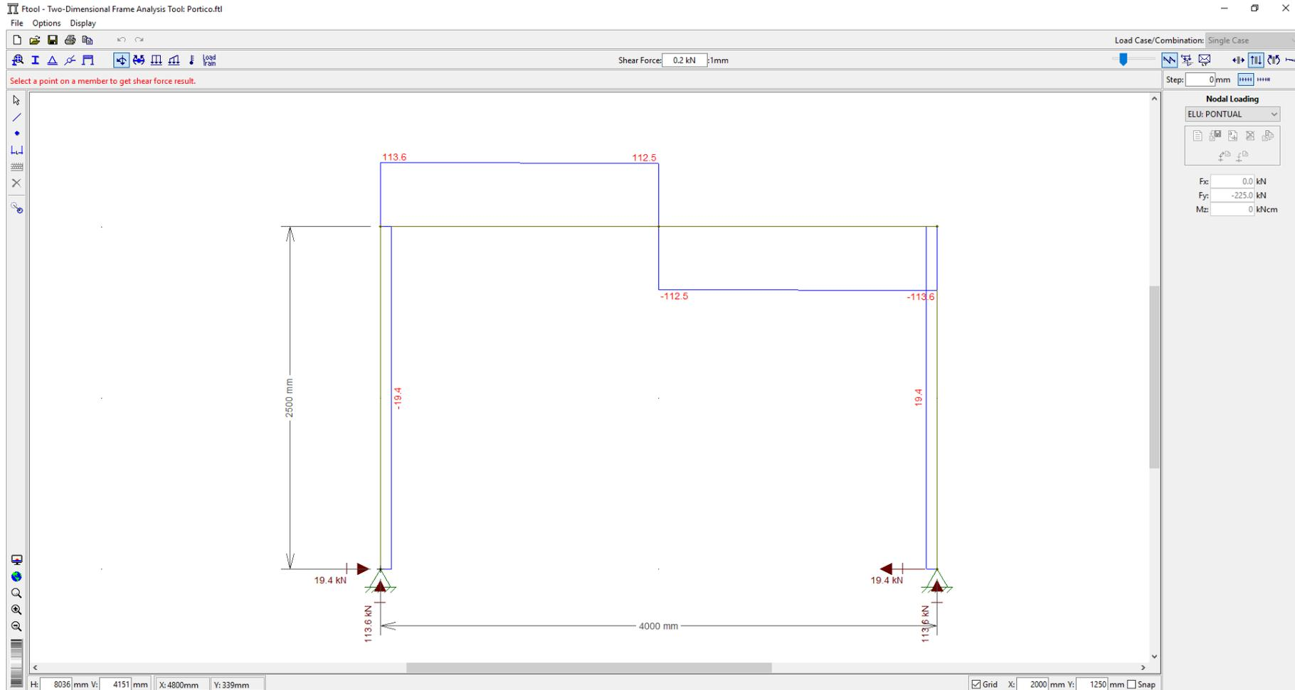
Cortante máxima na viga: 113,6 kN
