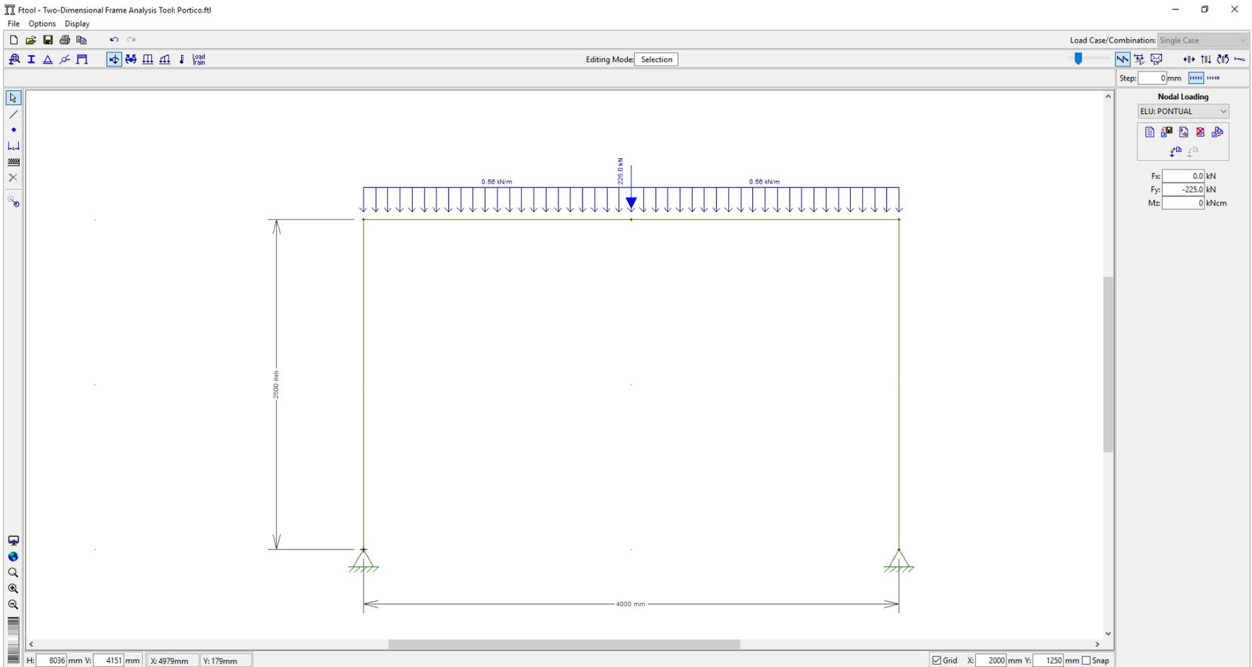
PP da viga: =  $1,25 \times 0,448 = 0,56 \text{ kN/m}$
