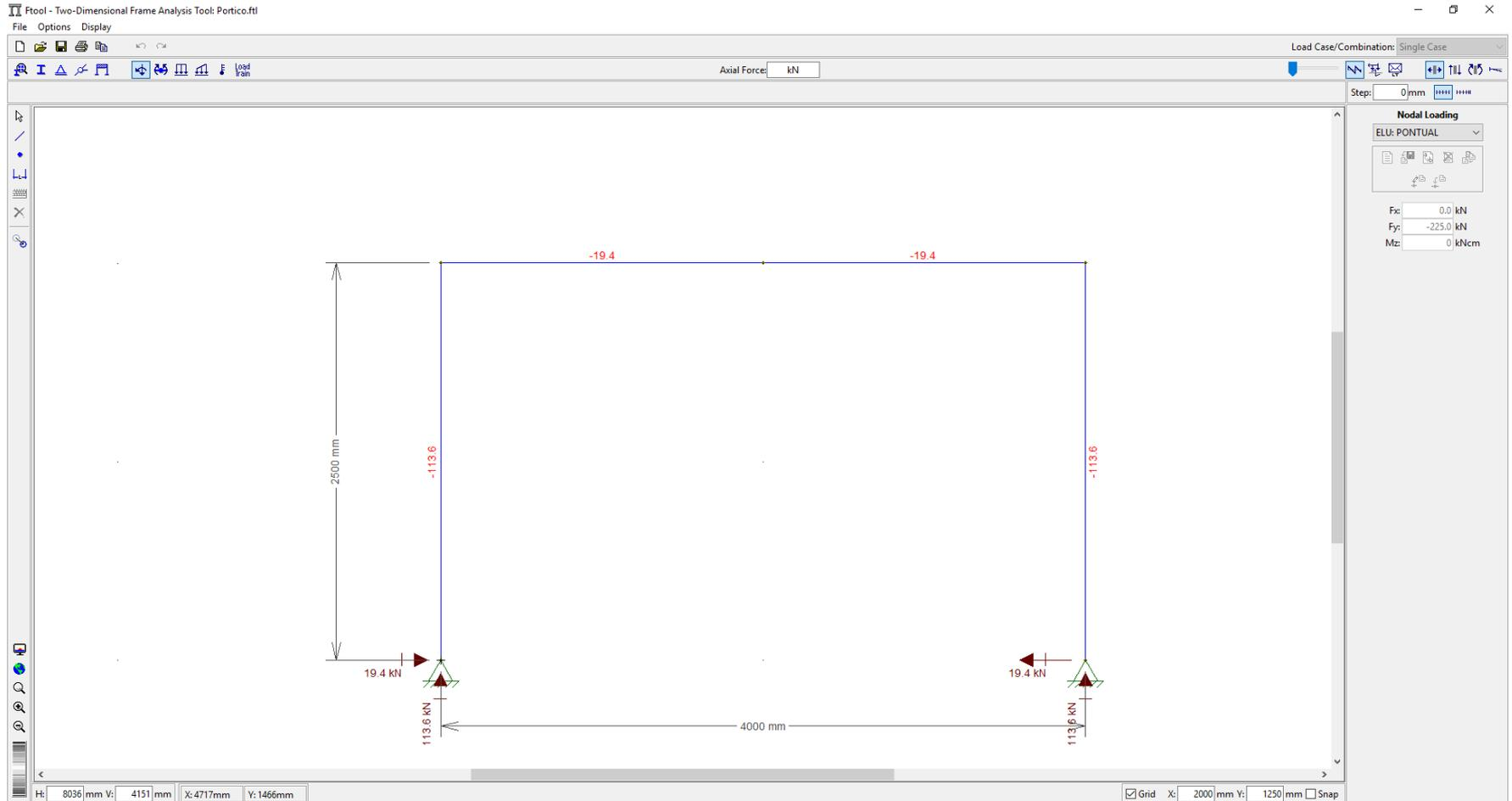
Axial na viga: 19,4 kN COMPRESSÃO
