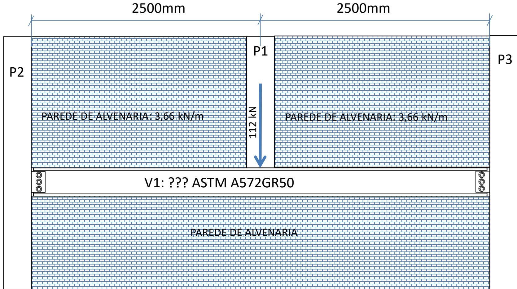
Determine a bitola da Viga de transição V1 relativamente à flexão na situação acima. Utilize Perfis W, H ou HP Aço Minas ASTM A572GR50. Assuma ligação articulada entre a viga V1 e os pilares P2 e P3. Assuma também que os pilares P2 e P3 permanecem indeslocáveis durante o carregamento. As cargas já foram devidamente majoradas na combinação mais desfavorável. ADOTAR COEFICIENTE MÉDIO DE MAJORAÇÃO = 1,47
