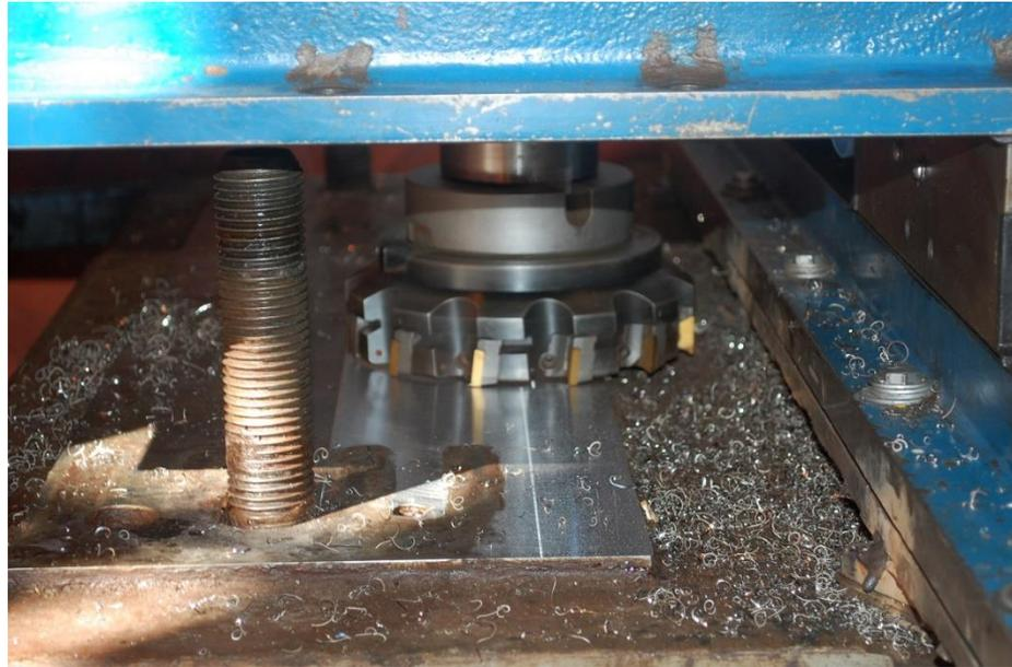
Chapas entre  $2''$  e  $4''$  de espessura podem ser usinadas somente na face de contato com a coluna, prever acréscimo de 5mm
