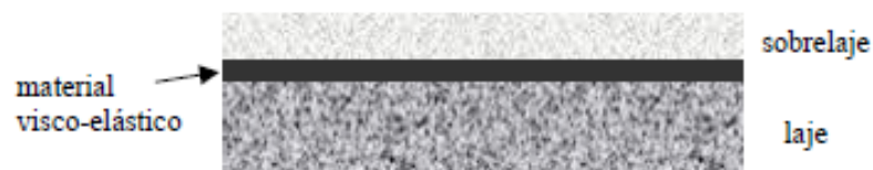
Figura III.6 - Aplicação de material visco-elástico entre a laje e a sobrelaje da estrutura de piso de um teatro [84].
