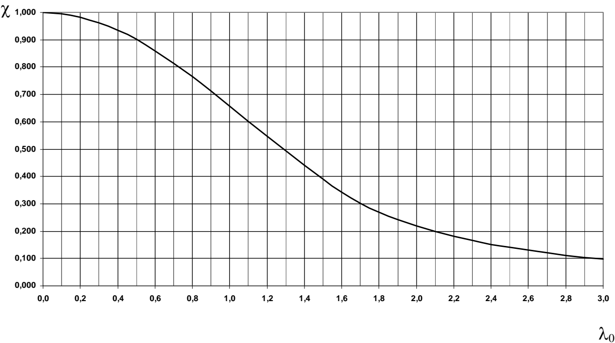
Figura 11 — Valor de \chi em função do índice de esbeltez \lambda_0
