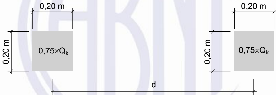
Figura 11 – Cargas concentradas para projeto de helipontos
