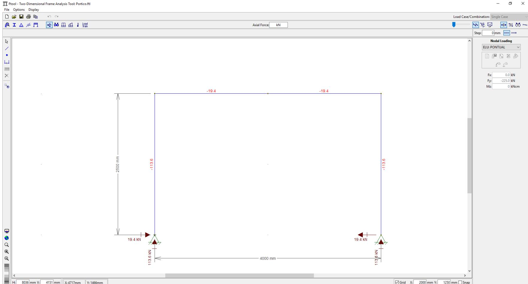
Axial na viga: 19,4 kN COMPRESSÃO
