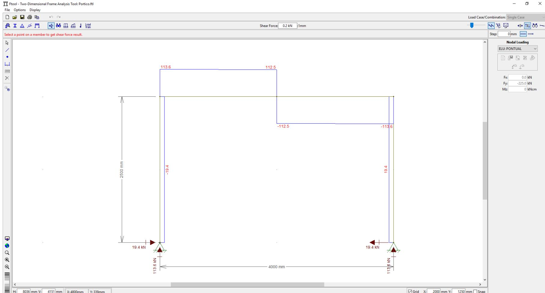
Cortante máxima na viga: 113,6 kN
